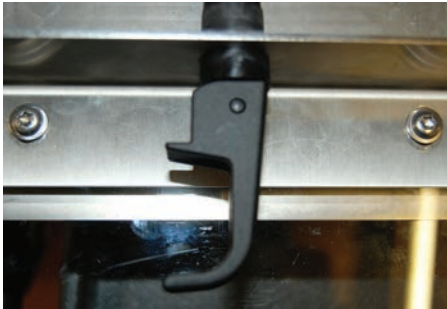
Levier de verrouillage ouvert sous le plateau du pupitre
