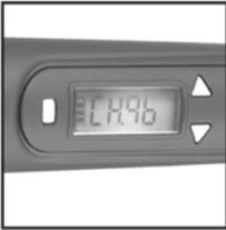
La charge peut facilement être connue grâce à la jauge de pile
