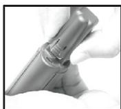
1. Retirez le capuchon du port (11) et le capot du compartiment des piles (9).
